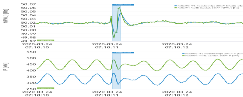
Slika 9- Promjene frekvencije i trofazne snage opterećenja u vrijeme detektovane brzine promjene frekvencije od -15.7\text{Hz/s} (10)
